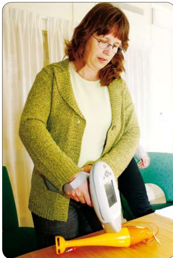
En av KemI:s inspektörer gör en snabbanalys av farliga ämnen i en stavmixer med hjälp av XRF-instrumentet.
